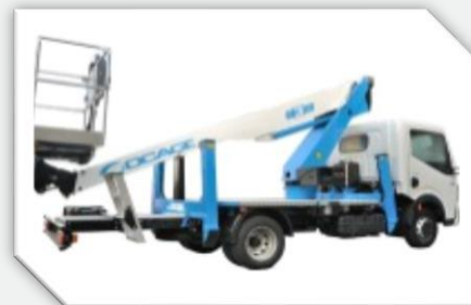
NISSAN CABSTAR (Автовышка) Установка SOCAGE T-320 (21 м)
